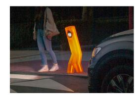
Mobiliario urbano inteligente con acabado Natural, diseñado para protección peatonal en cruces mediante balizas luminosas intermitentes.
